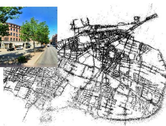
Figur 2: Var är bilden tagen? Givet en 3D-modell (i detta fall Malmö representerat av ett punktmoln) så är problemställningen att automatisk kunna lokalisera var bilden är tagen relativt modellen.
